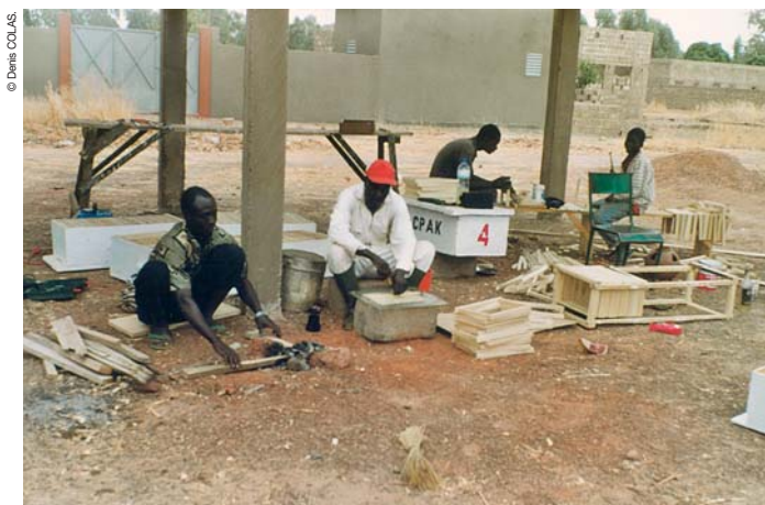
Ici, on fabrique les cadres et les plaques de cire pour les amorçages (Alioune M'Baye en casquette rouge, le responsable technique).
