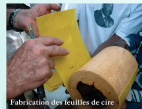
Fabrication des feuilles de cire
